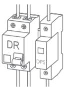
A NBR 5410 recomenda a utilização de um Dispositivo DR e de um Dispositivo de Proteção contra Surtos (DPS). O Dispositivo DR atua protegendo contra choques elétricos causados por fuga de corrente, enquanto o DPS desvia surtos de tensão que podem danificar equipamento eletroeletrônicos.
